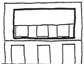
. LES SURFACES D OUVERTURE TROP IMPORTANTES, LES OUVERTURES PLUS LARGES QUE HAUTES, LES LUCARNES TROP LARGES
