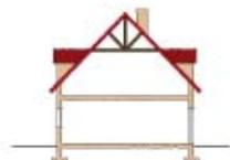
» Dans la maison basse, le relèvement des murs gouttereaux (dérapement) permet une meilleure utilisation du volume des combles
